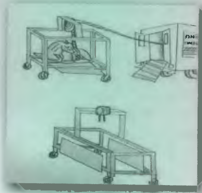
Resim 2: Kendi tasarladığımız büyük hayvan kurtarma ve taşıma sedyesi ve büyük hayvan kurtarma ve taşıma sedyesinin ambulansa entegrasyonu ve kurtarma vinci
